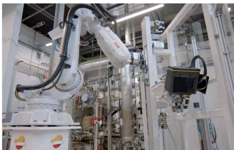
También se ha instalado en la planta piloto de refino un brazo robótico de cinco ejes que desplaza hasta 30 kilos de peso para la apertura y cierre de los reactores de esa planta. Con este brazo "buscamos mejorar la seguridad y probar esta tecnología para ver qué operaciones similares se podrían realizar con ella a escala industrial", prosigue Alfonso García.
